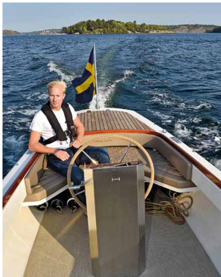
Viktor Norstedt vid den stabila styrpulpeten. Hydraulstyrning samt 9" plotter från Simrad är standardutrustning ombord.
