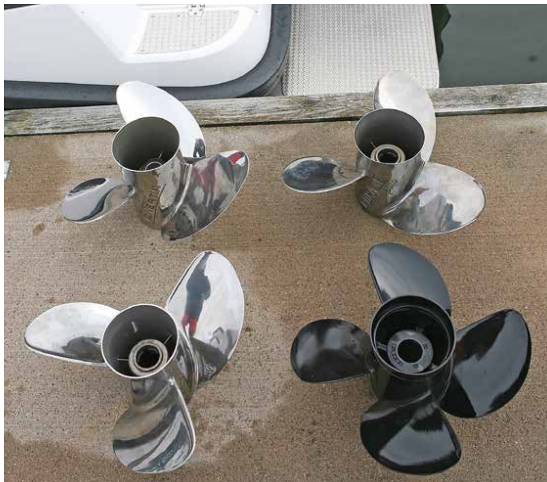
Fyra olika typer av propellrar testades med en 150-hästare, monterad på Bella Falcon BR7.
