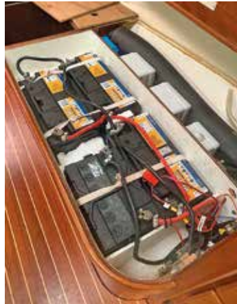
Originalinstallation med blybatterier.
