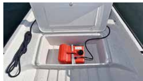
Plats för två 10-literstankar i akterfacket. Fördjupning för bränsleslangen i ramen under luckan.
