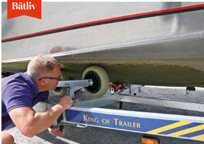
När man hittat rätt läge på båten så justerar man stödhjulen på var sida så att gummihjulen ligger an mot båtbottnen.
