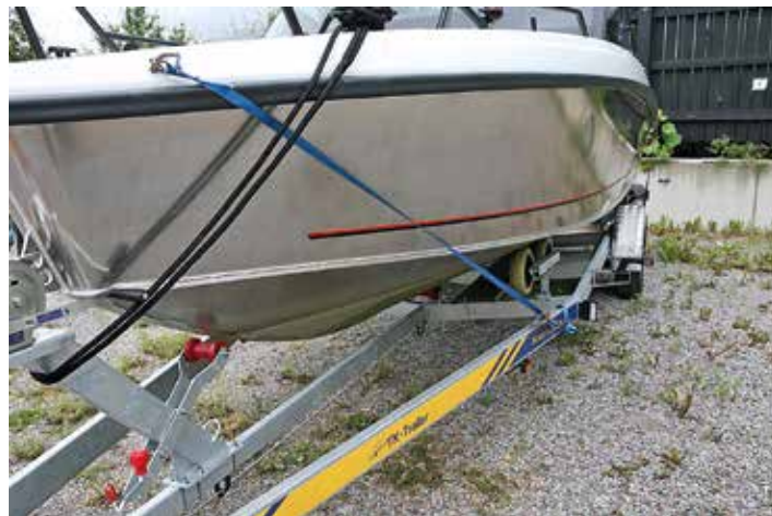
När man surrar båten vid trailern kan det vara en fördel att placera två spännband (de blåa) från stäven och akterut som bilden visar. Detta ger en extra säkerhet vid kraftiga inbromsningar.
