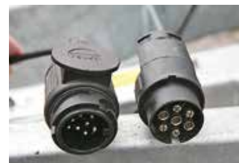
Släpvagnskontakter finns i olika utföranden. Har man en gammal kontakt på bilen och en nyare på trailern finns överföringar mellan 7-poliga och 13-poliga.
