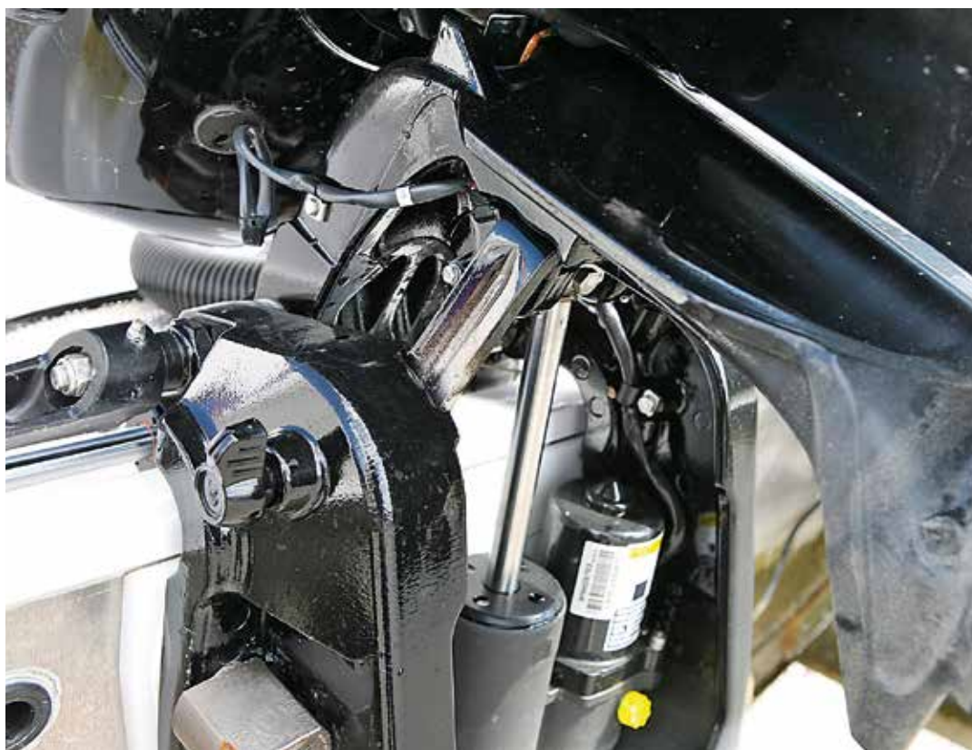
Vid körning på land måste utbordaren lyftas och säkras med den spärr sitter på ena sidan av motors monteringsbygel.
