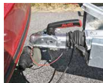
Den gröna knappen framför handtaget markerar att låsningen vid dragkulan är korrekt. Den röda säkerhetskedjan läggs runt draget på detta sätt för att påverka bromsen om trailern skulle lossna från dragkulan.
