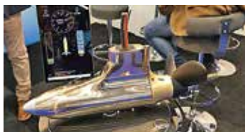
Podmotor från norska SeaDrive. Motorn finns i tre versioner på 7,5, 15 respektive 30 kW.
