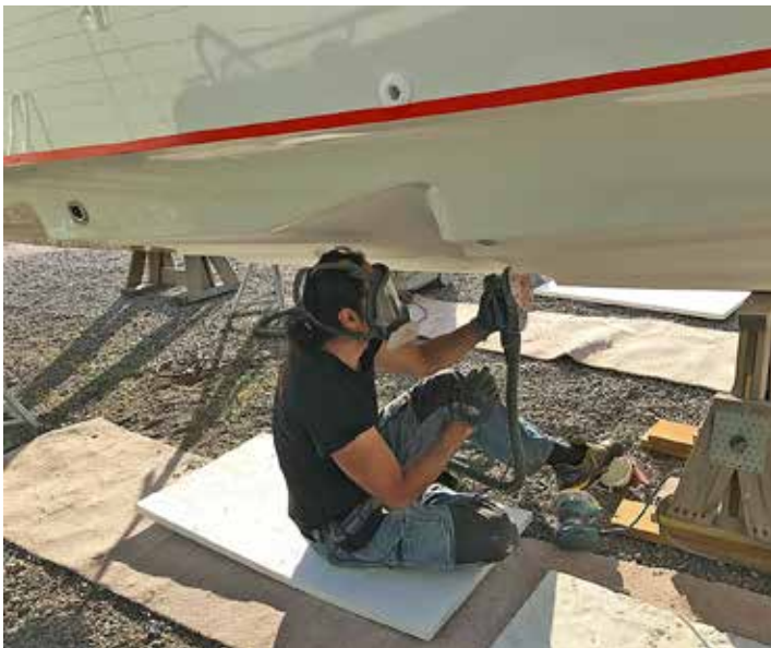
Markera vattenlinjen med PVC-tejp (som är lätt att lossa senare) och slipa hela botten med en maskin som är kopplad till en dammsugare. Slipa med en kornstorlek på 60–120. Spola av slipdammet med färskvatten och låt botten torka ordentligt.
