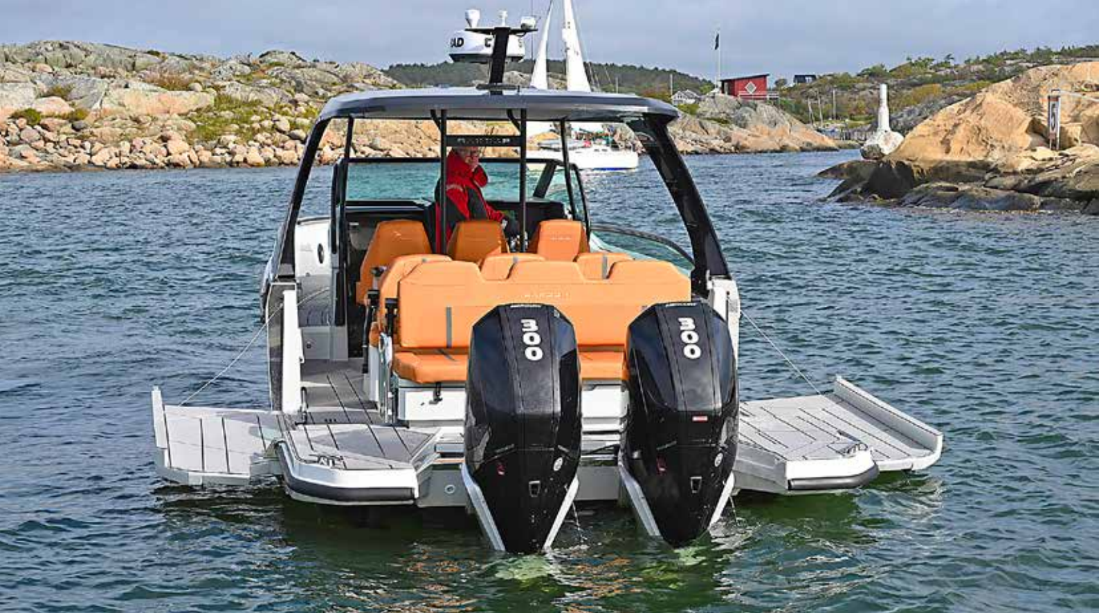
Saxdor 320 GTO med sina utfällbara skrovsidor. Två stora badplattformar på 80 x 200 cm manövreras med elektriskt styrda lyftare.
