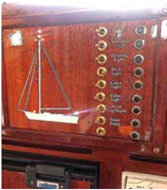
Ulf Wikström har byggt in en panel med knappar där lysdioder visar vad som är påslaget i båten.
