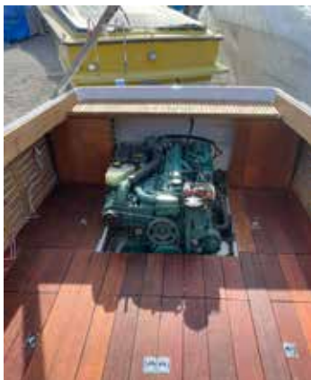
Originalmotorn var en Volvo B18. Idag sitter det en Volvo Penta KAD-44 med 290 DPE-drev i motorrummet.
