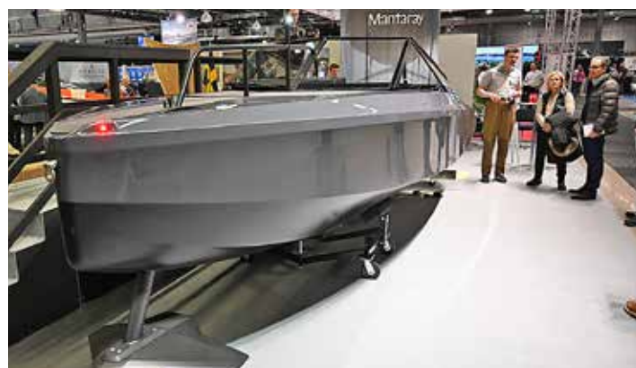
Mantaray M24 kan, enligt tillverkaren, revolutionera framtidens båtupplevelse med sin mekaniska självstabiliserande bärplanslösning. Båten har det patenterade bärplanssystemet Dynamic Wing Technology (DWT), vilket är en självstabiliserande och helt mekanisk bärplanslösning, som gör att den förbrukar upp till 75 procent mindre energi än konventionella båtar. Motorn är en utombordare. Den 24 fot långa båten har en topphastighet på över 30 knop och en marschfart på 25 knop.
