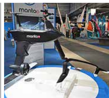
Manta5 Hydrofoil SL3 är en cykel som foilar fram över vattenytan. Den produceras i Nya Zeeland och har en marschfart på 6–7 knop. Batteritiden är upp till 4,5 timmar.
