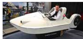
Bowter är en ny svensk båt. Den 5,05x2,02 m stora båten är eldriven och laddas via en solpanel på badbryggan.
