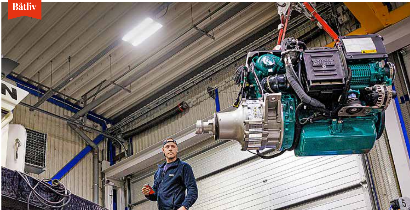
Volvo Pentas nya hybridsystem installeras i en båt byggd av svenska Marell Boats. Drivlinan baseras på Volvo Penta D4/D6 Aquamatic DPI.
