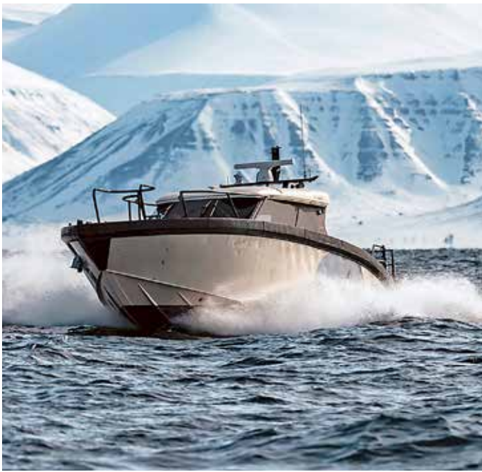
Volvo Penta och Hurtigruten samarbetar med Marell Boats. Båten på bilden är utrustad med två Volvo Penta D4-320 DPI Aquamatic hybrid. De ger en toppfart på 32 knop och en marschfart på 25 knop. Räckvidd 500 M.
