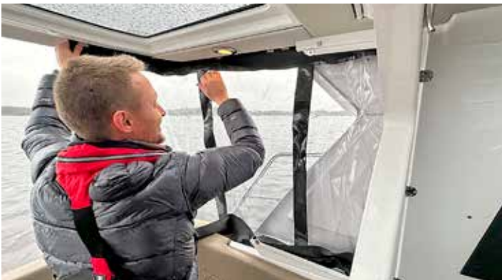
Båten har en mycket speciell kapell-lösning. På var sida i överbyggnaden öppnar man upp en lucka och drar ut kapellet runt den akre sittbrunnen.
