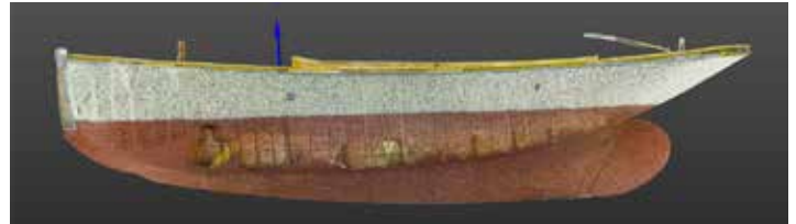
Både kontrollmätningar och skanning bekräftar att Edda är Kummelnäsaren på ritningen från 1886. Foto: Anders Jansson / Scanders.
