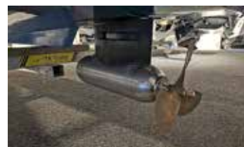
Podden med elmotorn är robust byggd med ett hölje i duplex rostfritt stål. Svängbar 360 grader.
