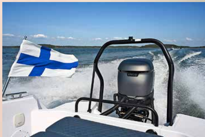
Elmotorn drivs med 800 Volt och har 2x63 kWh Kreisel batterier. Batterierna kan laddas på en timme.
