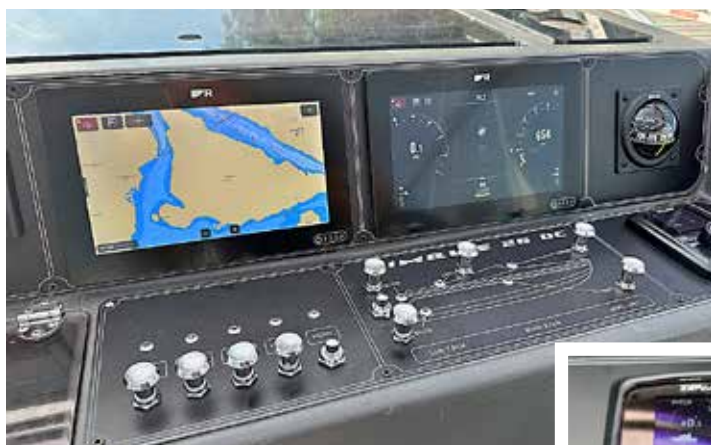
Instrumentpanelen med två niotums plottrar för navigation och motordata.
