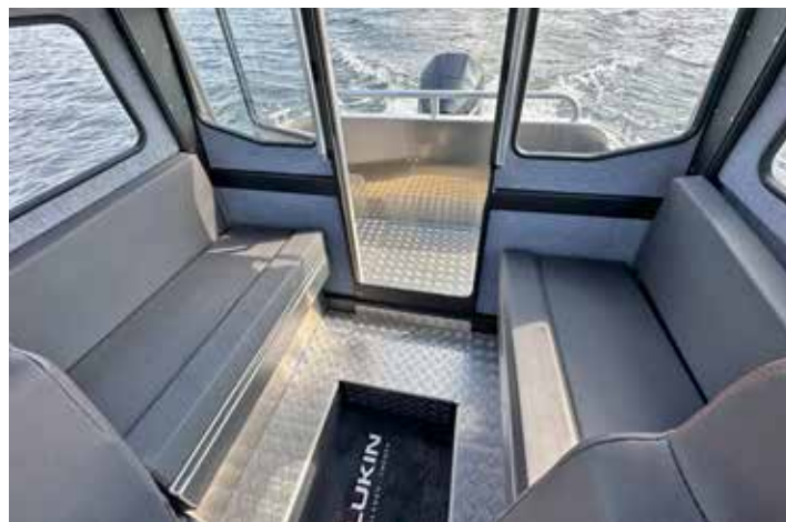
Akter om de båda fätöljerna har Alukin C650 två långsgående bänkar med plats för fyra personer.
