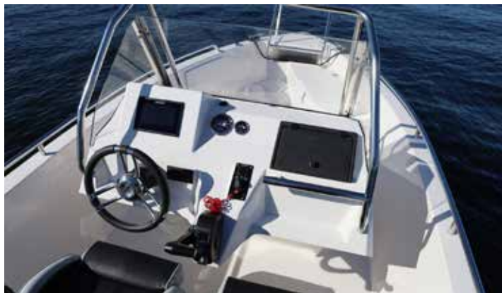
Styrpulpeten är bred och runt om vindrutan sitter ett kraftigt handräcke i rostfritt. Framför ratten har tillverkaren lagt in en smart konsol där en kartplotter kan fällas in.
