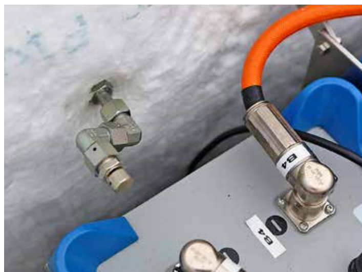
Batteripolerna har en speciell låsning som gör att man inte kan koppla bort en anslutning vid drift och komma åt några strömförande delar.
