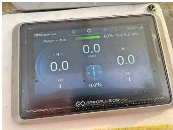
En 5-tums display visar all information om elmotorerna och batterierna. Den första visningen är att båda motorerna är aktiva och redo att användas.
