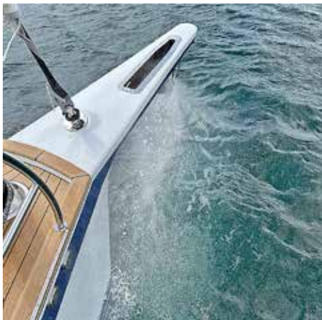
Ankaret i fören spolras av med egen dusch när det dras upp. Kättingen är rostfri för att minimera ljudet.
