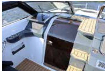
Askeladden har valt små, fasta steg till vänster om förarplatsen och en separat skjuddörr i plexiglas till den främre kabinen.
