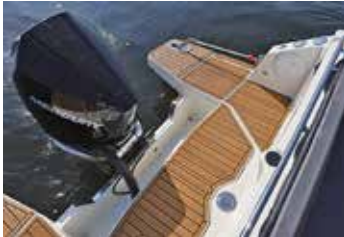
Uttern D77 har förlängda badplattformar på var sida om motorn och även en betydligt bredare motorbrunn med plats för två utbordare.
