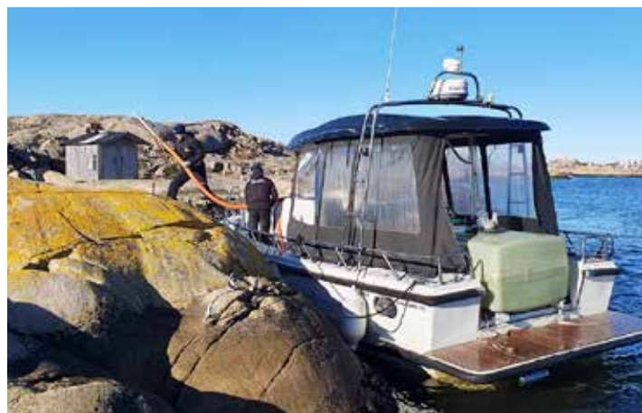
Båt med mobilt slamsugningssystem, Saxen, Sotenäs kommun. Foto: Västkoststiftelsen.
