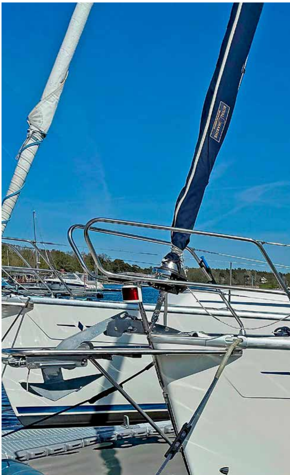
Kapell på focken skyddar segelduken. Men vid motorgång tar det längre tid att rulla ut seglet om inte kapellet är borta.
