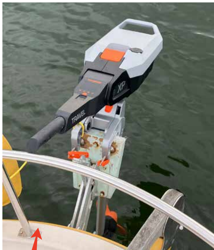
Torqeedo Travel XP (1 600 W) med integrerat batteri motsvarar ungefär en 5 hk bensinutombordare.
