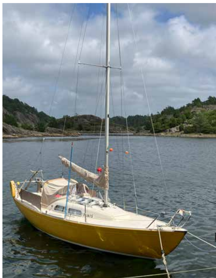
IF-båten med ett displacement på 2 150 kg passar bra för elutombordare. ➔
