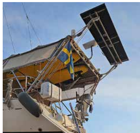
Två solceller på 150W vardera monterades ovanpå jolledäverten.
