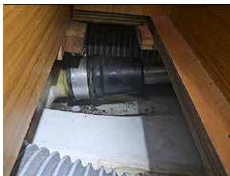
Den läckande propelleraxeltätningen byts ut i Port Saint Louise.
