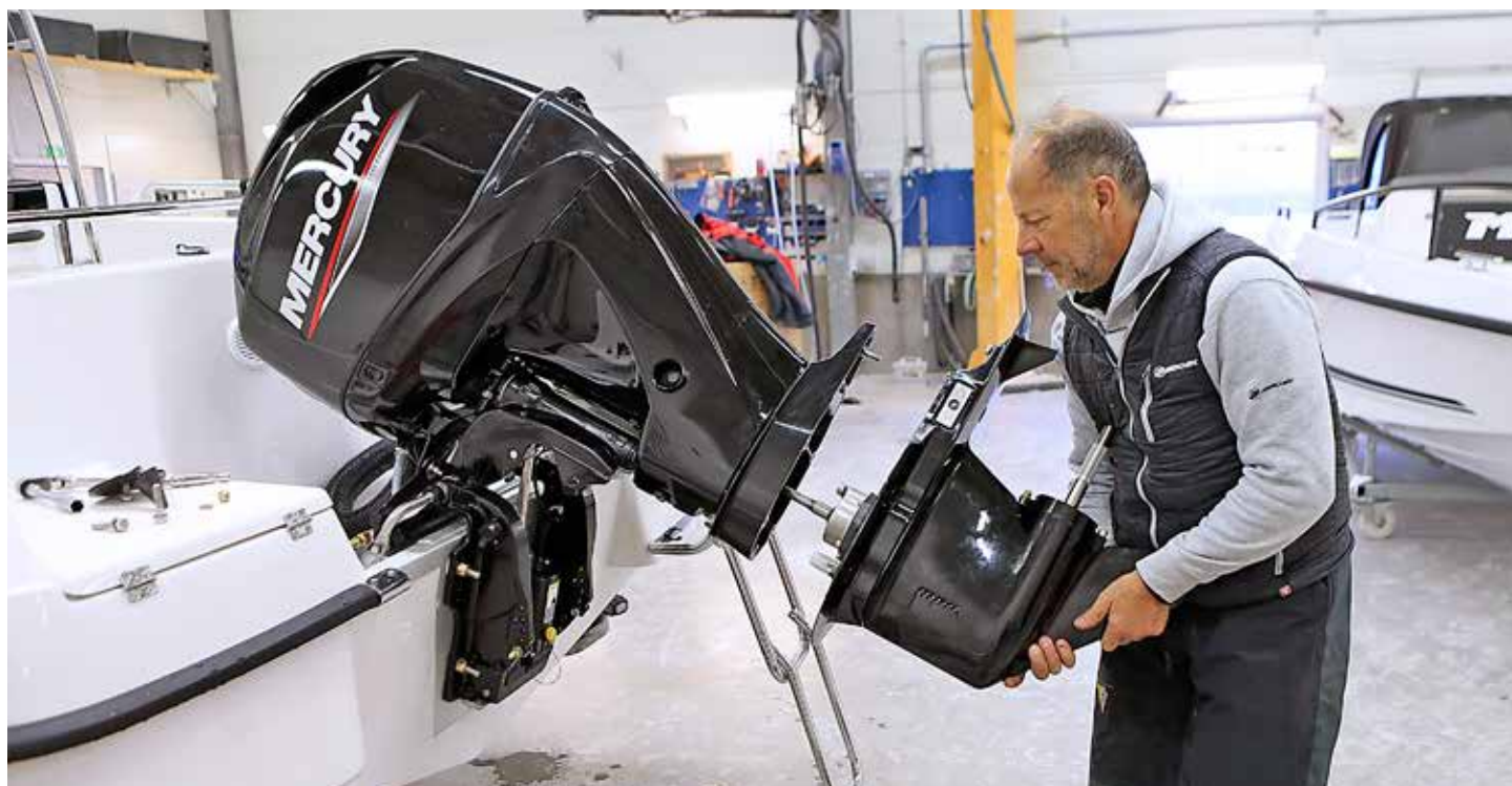
Mercurys 60-hästare testades även med ett större växellhus typ Command Thrust som är utformat för att driva propellrar med en större bladarea.
