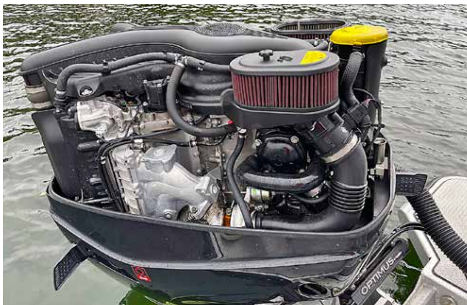
Nya Cox 300 V8 är en mycket kompakt dieselsnurra med en volym på 4,4 liter och ett vridmoment på hela 998 Newtonmeter.
