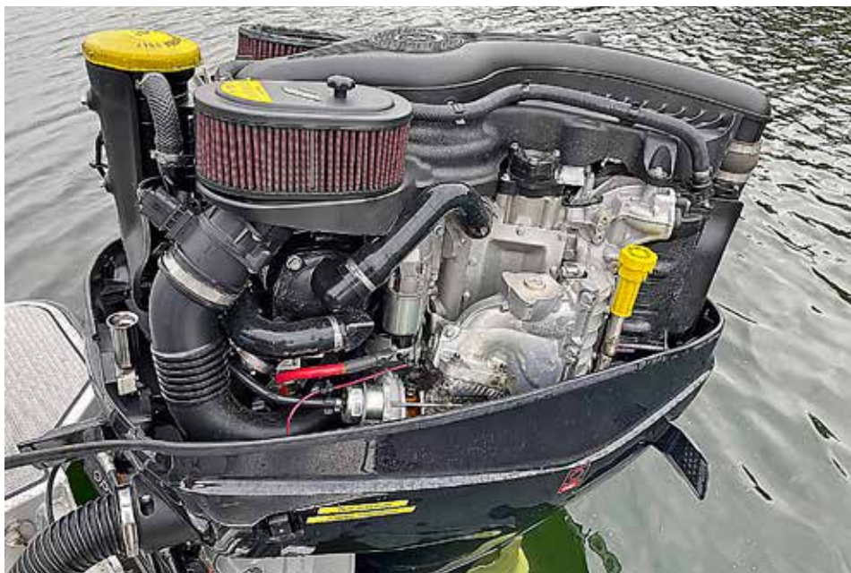
Motorns vänstra sida med ett av sina stora luftfilter och flera servicepunkter markerade med en gul färg.
