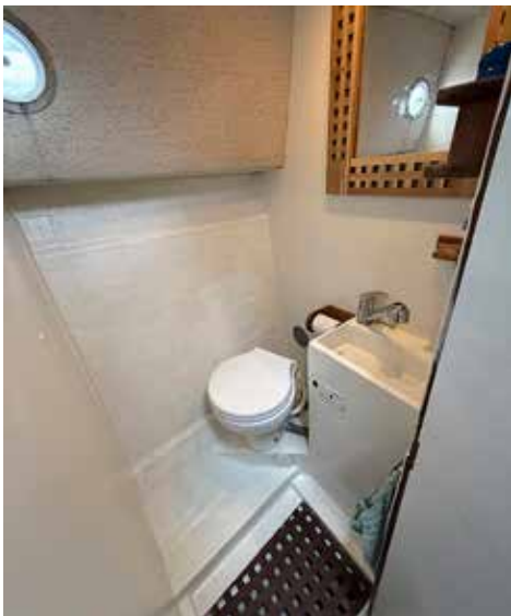
Toaletten har Jimmy byggt om ordentligt. Returvattnet från duschen används i toaletten.
